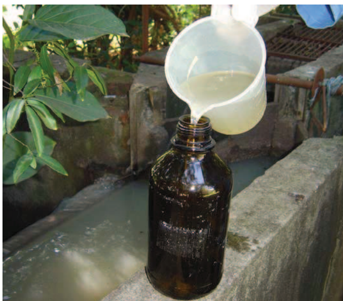
Figura 3.27 – Coleta do esgoto para a caracterização.
