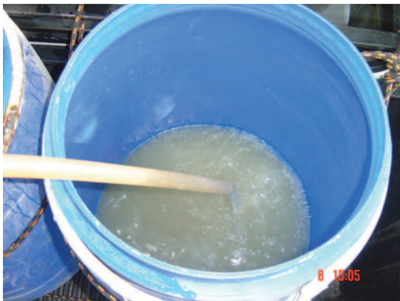
Figura 3.31 – Armazenamento do esgoto para o equipamento de colmatação
