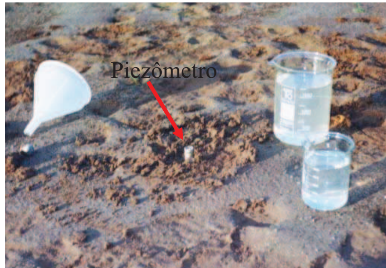
Figura 3.35 – Foto do ensaio de infiltração em piezômetro.
