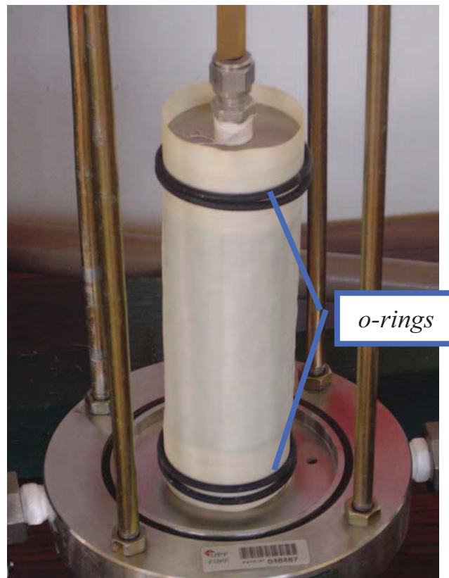
Figura 4.13 – Cilindro do solo com corpo de prova revestido com membrana de látex.
