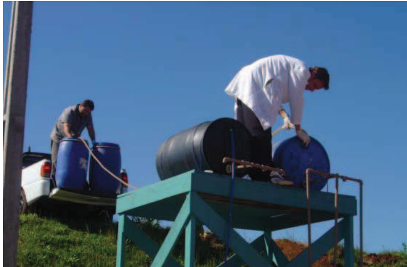
Figura 4.18 – Abastecimento do equipamento de colmatação com efluente.
