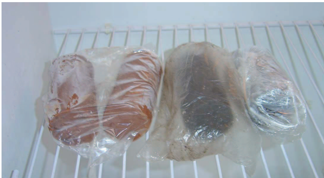
Figura 3.22 – Corpos de prova para o equipamento de coluna conservados sob refrigeração.
