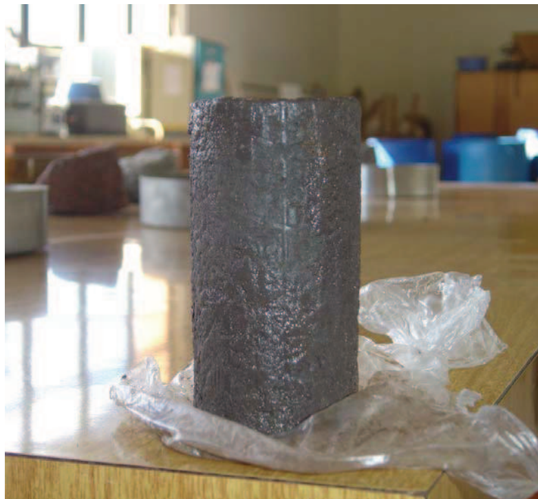
Figura 3.23 – Corpo de prova da área de corte para uso no equipamento de coluna.
