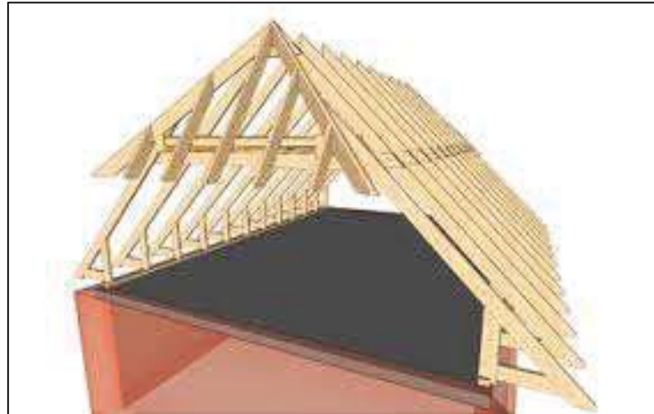
Figura 28 - Imagem de tesoura krüppelwamdach
