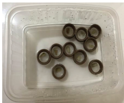
Figura 28 - Amostras em recipiente plástico cobertas por água destilada.
