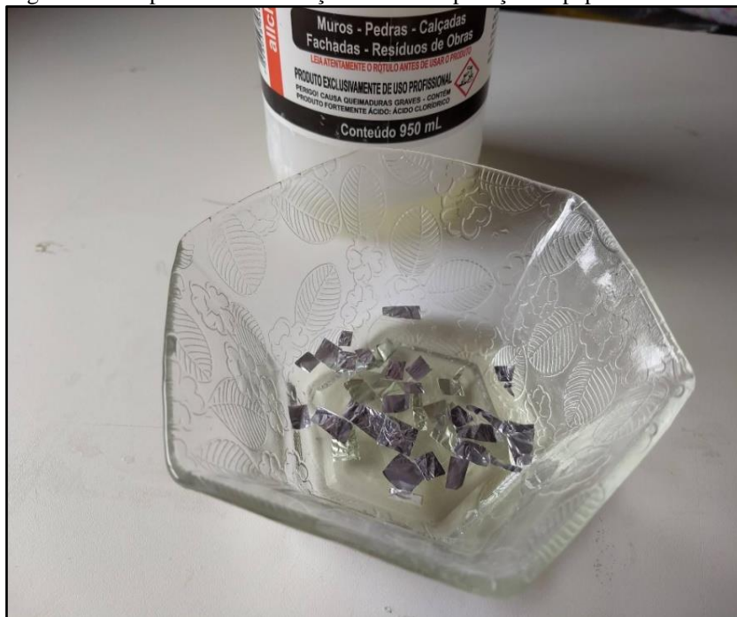
Figura 9 - Recipiente com a solução ácida e os pedaços de papel alumínio
