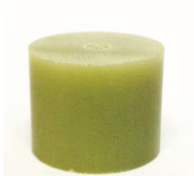
Figura 4. Base em G10 de 1 polegada (25,4 mm) de diâmetro e 20 mm de altura.
