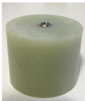
Figura 6. Implante instalado na perfuração do G10.
