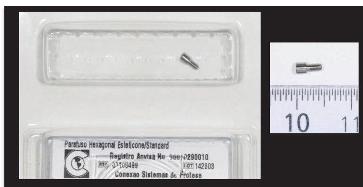
Figura 25. Parafuso de fixação oclusal para pilares Speed customizado, no qual foi aplicado torque de 10 N/cm 2 .
