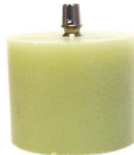
Figura 11. Estação com pilar instalado no implante.
