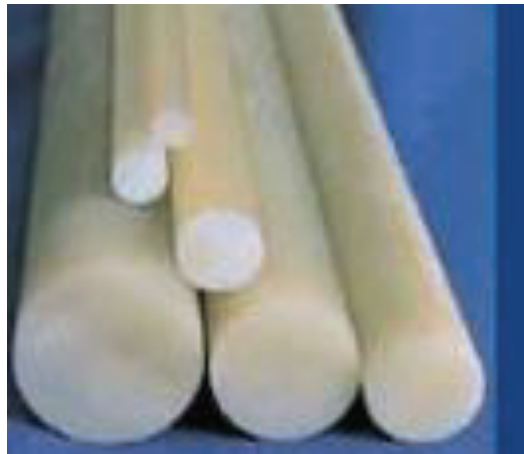
Figura 3. O compósito G10 é comercializado na forma de bastões de diferentes diâmetros.
