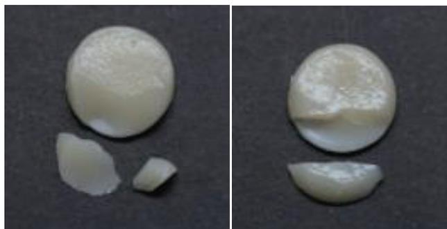
*Figura 10. Imagens representativa do modo de falha delaminação*
