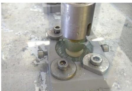
*Figura 6. Ciclagem mecânica dos corpos de prova com pistão de G10*
