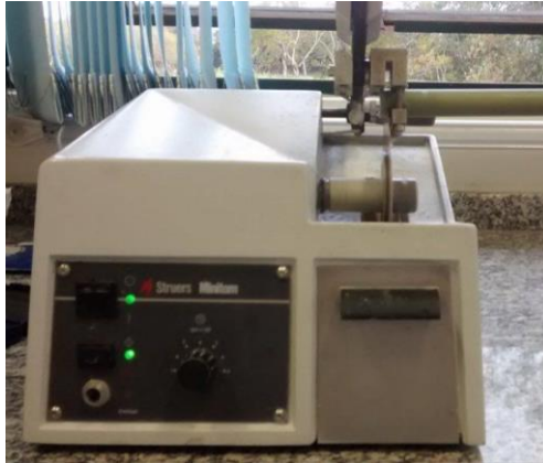
Figura 3. G10 posicionado na cortadeira metalográfica
