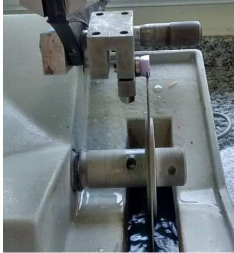
Figura 2. Bloco IPS e.max® CAD posicionado na cortadeira metalográfica
