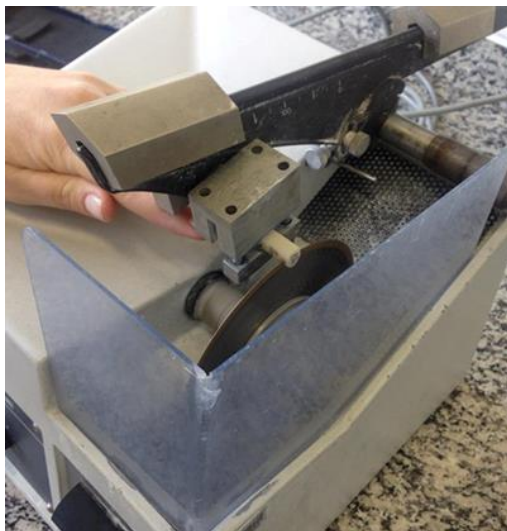
Figura 1. Bloco Vitablocs® MarkII Classical posicionado na cortadeira metalográfica.
