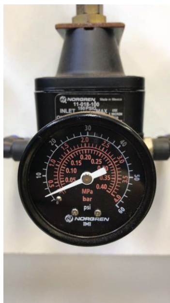
Figura 13 – Leitura do pressostato com a pressão aplicada
