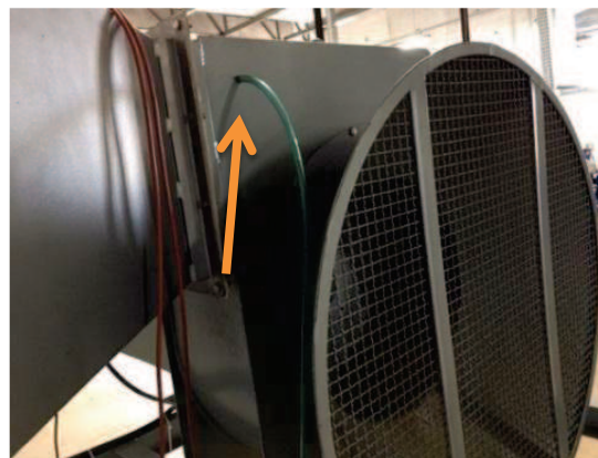
Figura 9 - Sistema de injeção de O_3 no secador de queijo ralado
