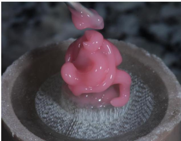
*Figura 13-Pilar de G10 sendo condicionado com ácido fluorídrico.*
