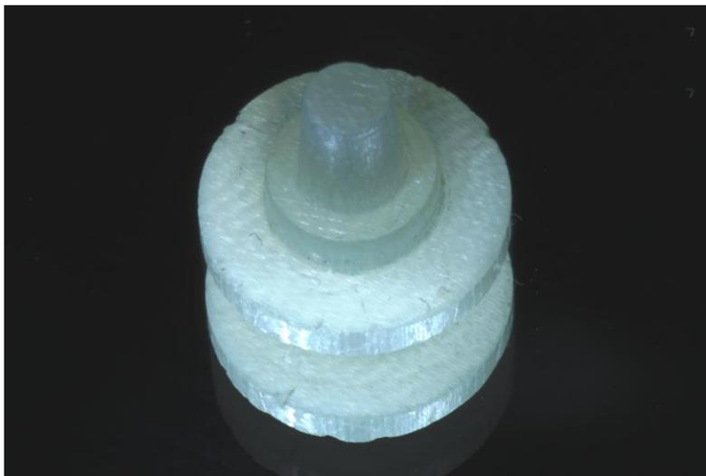
*Figura 2-Imagem do modelo de resina reforçada com fibra de vidro (G10).*
