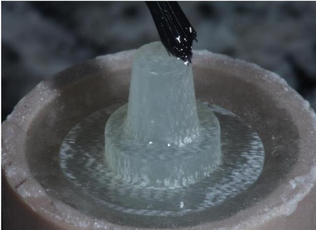
*Figura 15- Imagem do pilar de G10 recebendo a aplicação do adesivo.*
