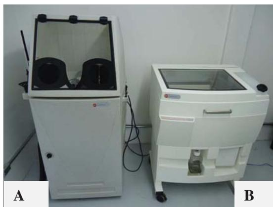
A) Cabine de limpeza e infiltração; B) Máquina para impressão 3DP.
