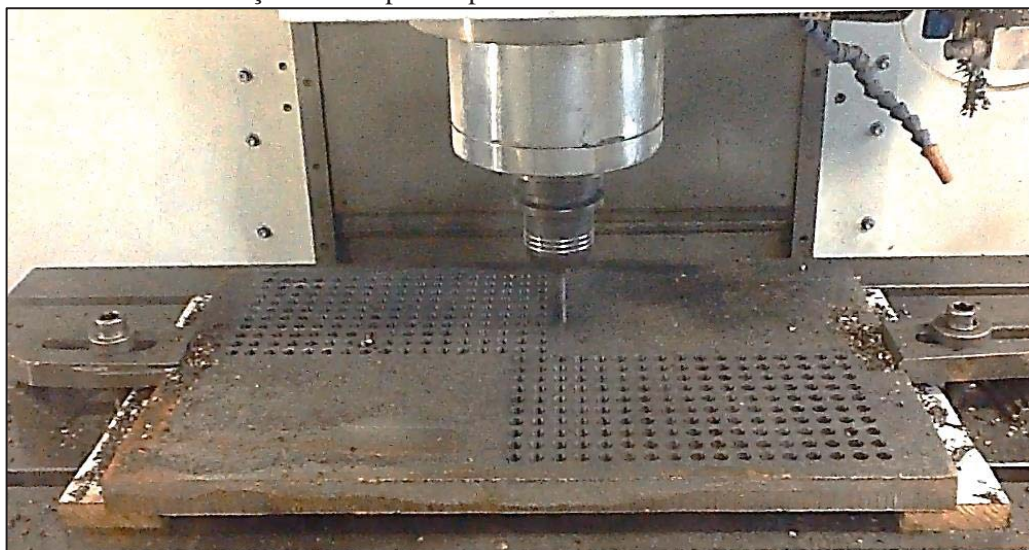
Figura 47 – Detalhes da furação dos corpos de prova.
