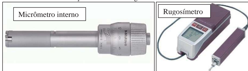
Figura 72 – Instrumentos de medição de diâmetro e rugosidade.
