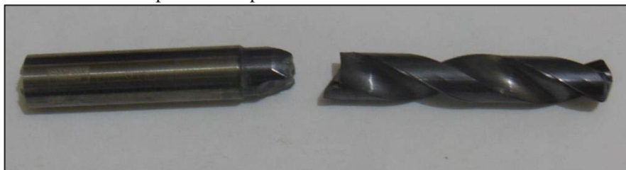
Figura 65 – Detalhe da fratura apresentada pela broca 8.
