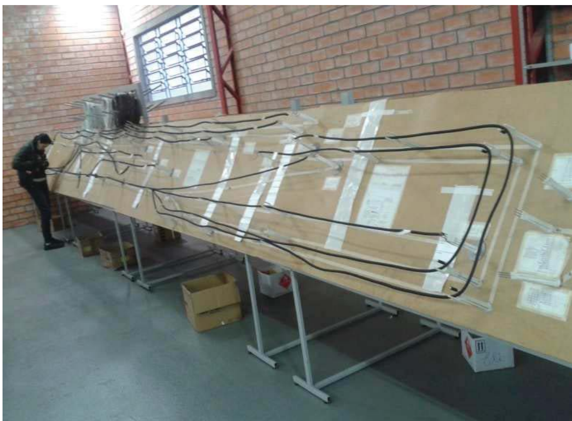
Figura 34 – Montagem de uma rede elétrica em gabarito
