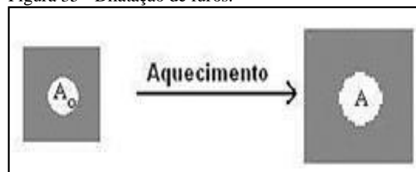
Figura 35 - Dilatação de furos.
