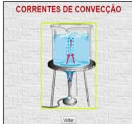
Figura 46 - Demonstração Convecção nos fluídos.
