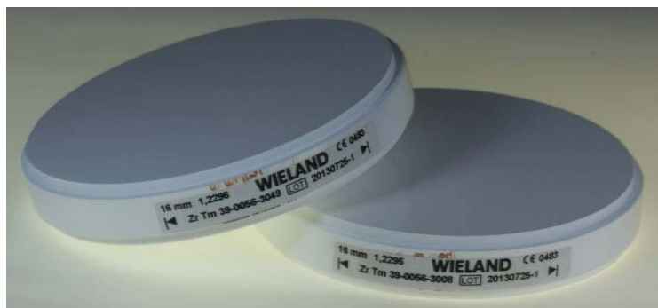
Figura 2: Blocos em forma de disco de zircônia tetragonal parcialmente estabilizada por ítria (Zenostar Zr Translucent®, Wieland Dental, Ivoclar Vivadent, Alemanha).
