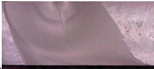
Figura 11: Lascamento a 0,6 mm da borda envolvendo a base do CP de YZ-NC com 2 mm de espessura. Esse resultado constante inviabilizou o uso dessa espessura de CP e motivou o aumento de espessura dos CP para 5 mm.
