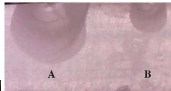
Figura 13: Imagem de perfil dos lascamentos produzidos a 0,3 mm da borda (A) e a 0,2 mm da borda (B) em CP de YZ-NC com espessura de 2 mm.
