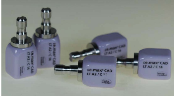
Figura 1: Blocos de vitrocerâmica a base de dissilicato de lítio (IPS e.max CAD® - Ivoclar Vivadent, Schann, Liechtenstein) na cor azulada típica da pré-sinterização.
