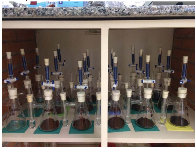
Figura 6 - Respirômetros para análise da toxicidade do nFeZ.
