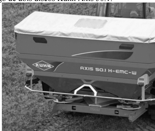
Figura 19 –Distribuidor centrífugo de dois discos Kuhn Axis 50.1.
