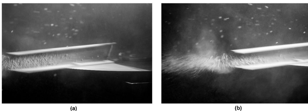
Figura 47 - Fotografia exibindo as partículas (a) ascendendo na palheta durante sua saída do disco e (b) expelindo pó após o impacto final com a palheta.
